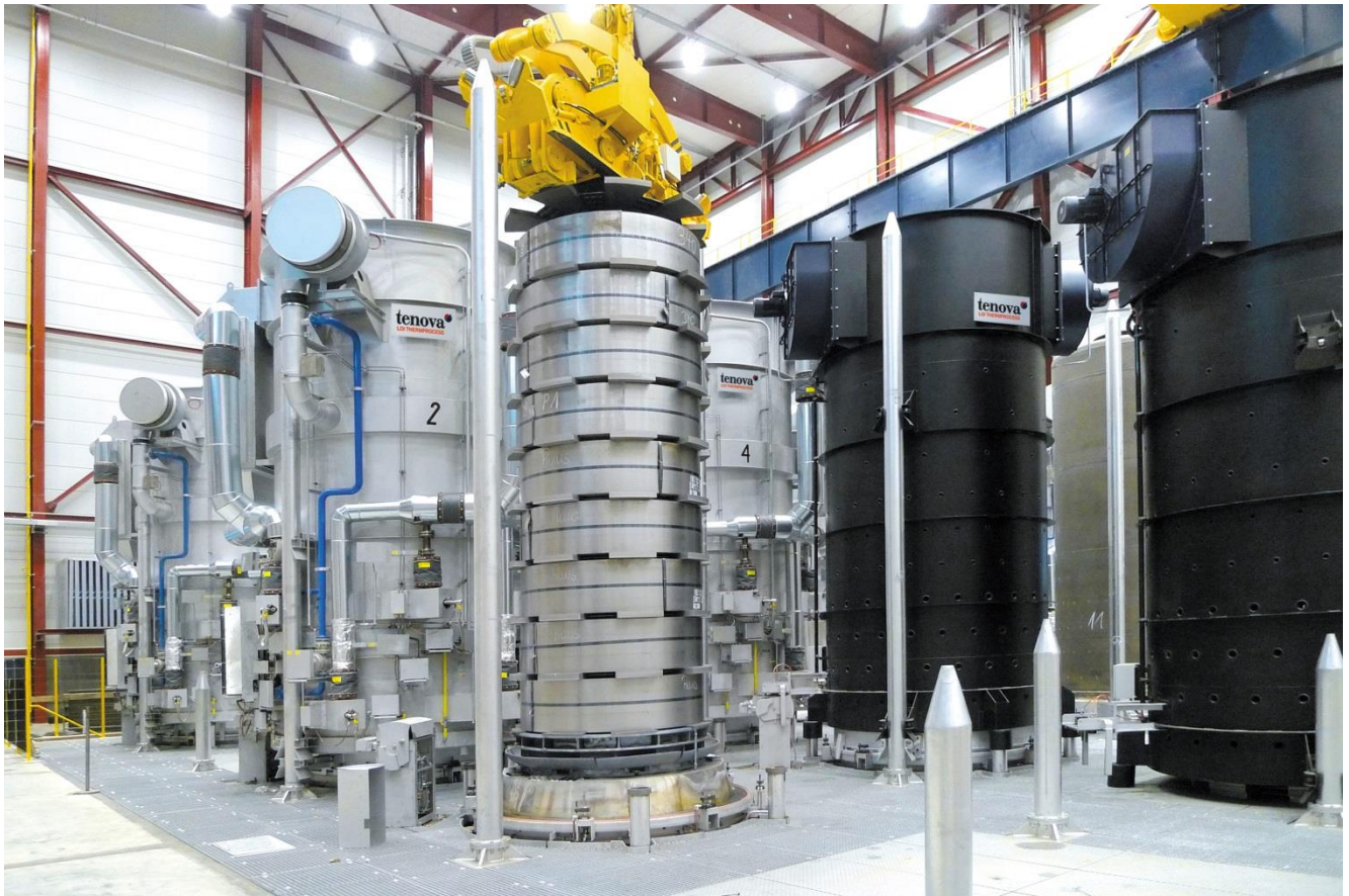
Bild 1: Tenova LOI Haubenglühanlage mit vollautomatischem Kranbetrieb bei BILSTEIN, Hagen-Hohenlimburg
