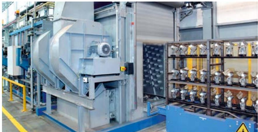
▲ Luftabschreckkammer für Strukturbauteile
