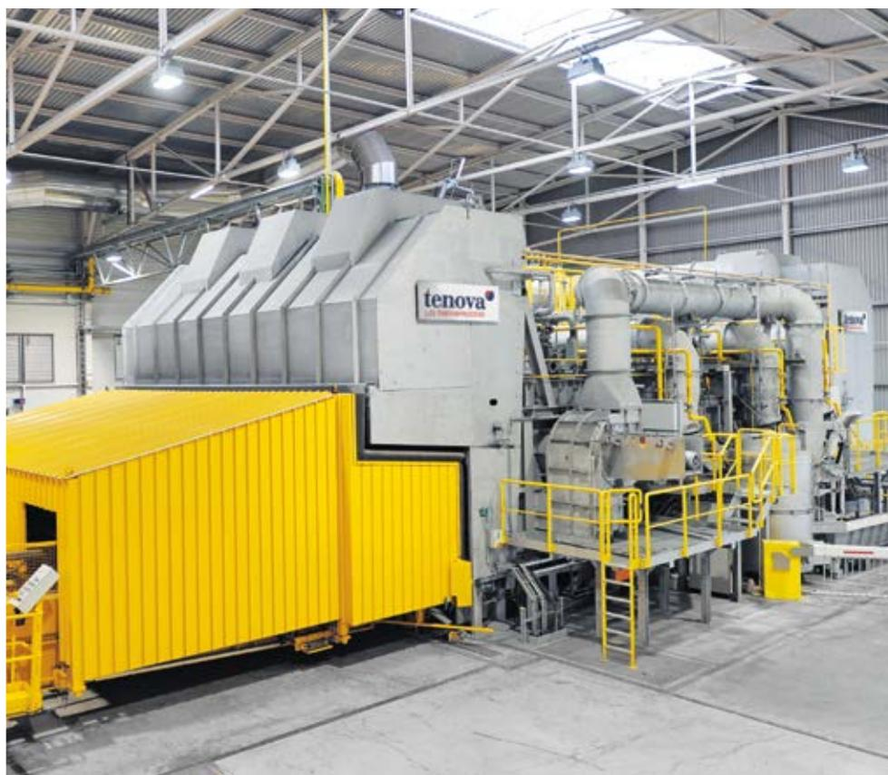
◀ Zweikammer-Schmelzofen TCF® mit automatischer Chargiermaschine CM
