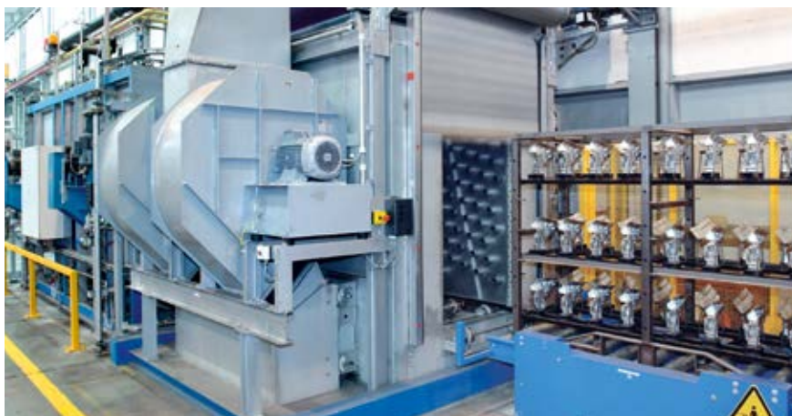
▲ Камера воздушной закалки для конструкционных деталей
