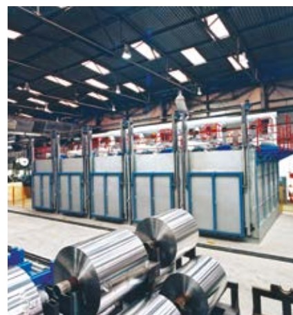
▲ Многокамерная печь для отжига ▼ фольги FAL
