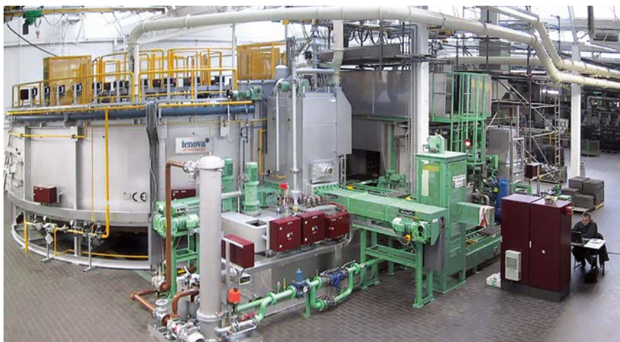
▲ Кольцевая печь с различными зонами Tenova LOI Thermprocess для газового науглероживания элементов редукторов и закалки/отпуска стали.
